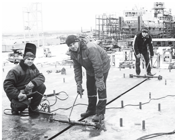
▲ Бригада Батова ведет работу по стыковке в секции баржи
